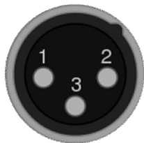
Рисунок 12 – Разъем подключения абонентской линии
