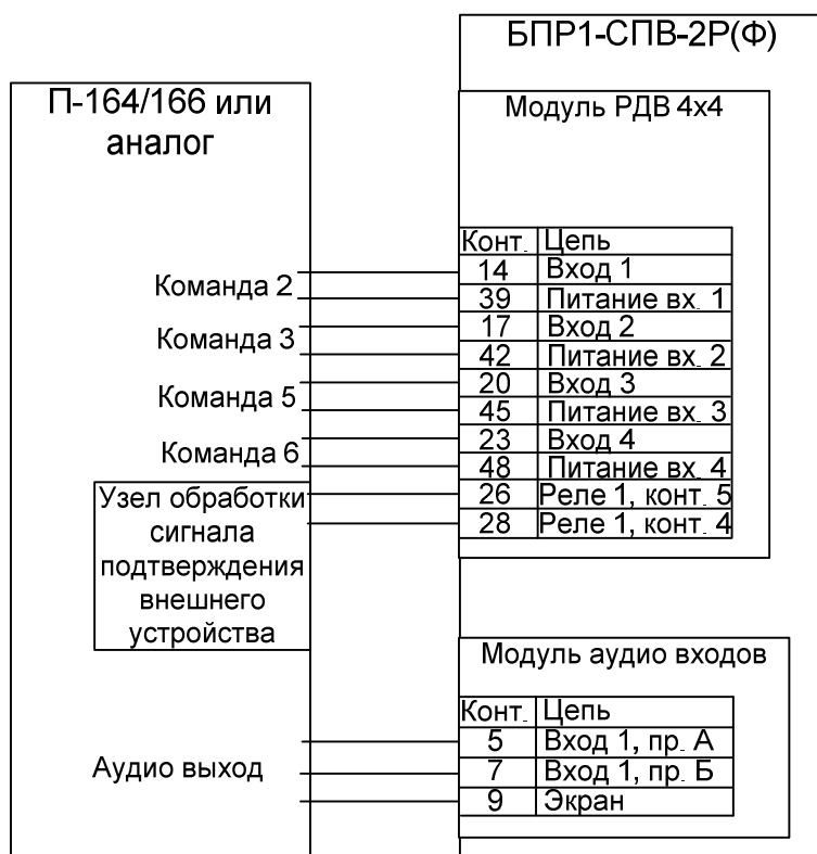
Рисунок 28 – Схема подключения БПР1-СПВ к оборудованию П-164
