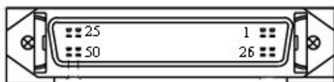
Рисунок 14 – Разъем модуля 4 реле/4 входа
