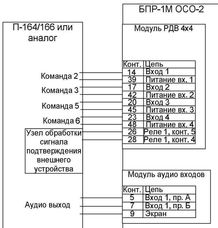
Рисунок 28 – Схема подключения БПР1-М к оборудованию П-164/166
